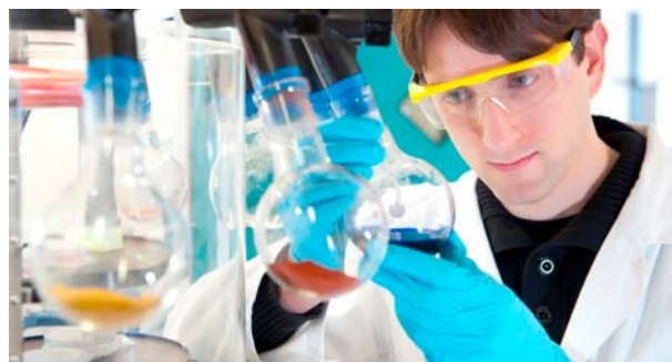
Nico Mehl bringt Kolben mit Proben zum Gefrierdrehen am Lyophilisator an . Foto: HZI, Bellhäuser
