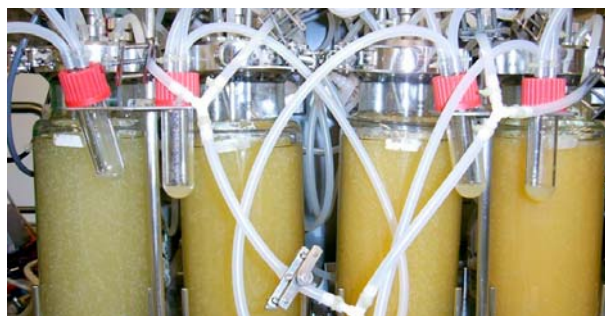
Parallele Fermentationen mit FxGBF13 unter verschiedenen pO_2 -Bedingungen Foto: HZI
